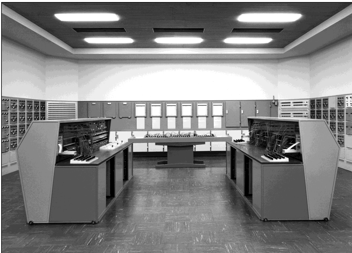
De Deltar (Delta Getij Analogon Rekenmachine)
