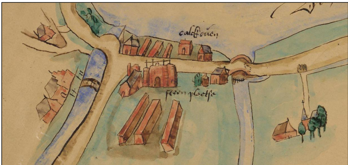
Afbeelding van een steenplaats en een calckoven aan de Rijn bij Ter Wadding op een kaart van Pieter Sluyter, landmeter van Rijnland (ca. 1550), De stokken boven deze oude steenovens waren voor het afdekken van de oven met rieten matten indien het regende.
